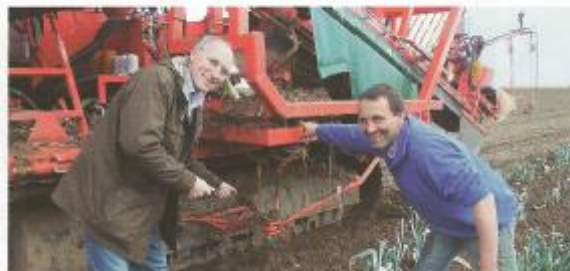
Werner Trinkel (l.) vertreibt, Thomas Zell nutzt den Ernter: An diesem Drehgelenk wird der Rodearm umgewendet.
