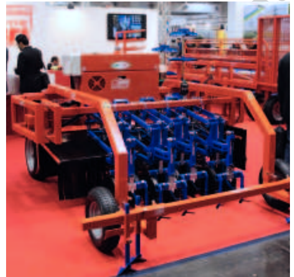
Diese neue Maschine von der Firma Ferrari heißt „Removweed“. Mit Infrarotsensoren werden die Reihen und Pflanzen erkannt für die mechanische Unkrautbekämpfung.
