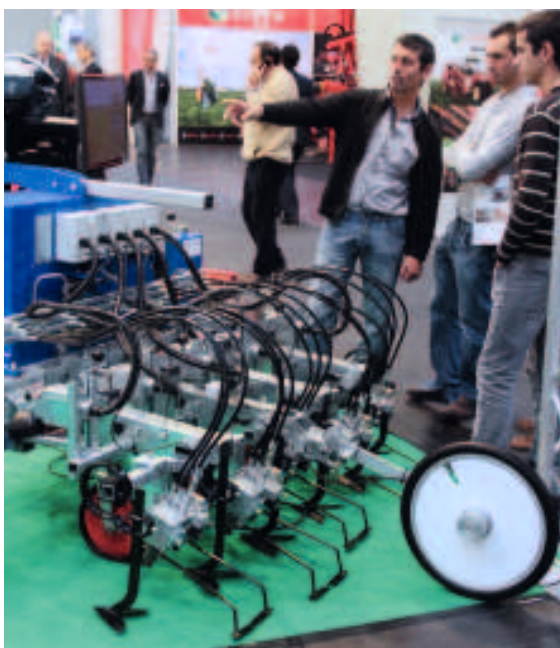
Auch die Firma KULT, Kress umweltschonende Landtechnik, aus Vaihingen widmete sich dem Thema mechanische Unkrautbekämpfung mit dem Robovator (l.), einer Coproduktion von Kress mit einer dänischen Firma. Der Robovator erkennt jede Pflanze und führt die Hacken drumherum. Auch mit der Duohacke (Mitte) wird die Kultur so nah wie möglich an das Gepflanzte sauber gehalten.
