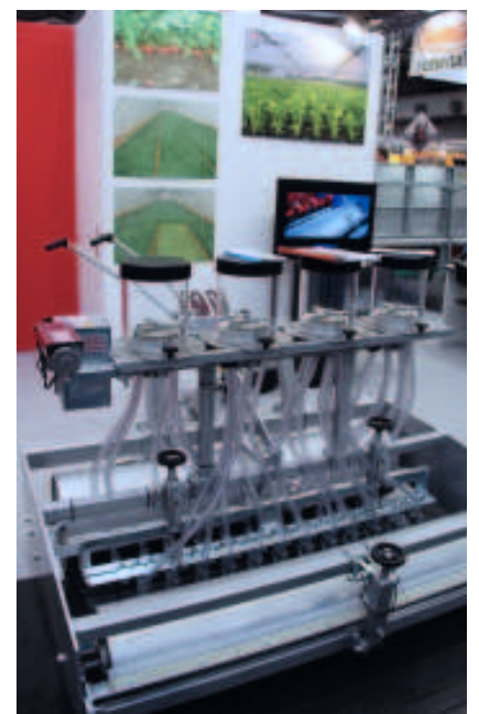
Die Sämaschine von Bassi kann sehr gleichmäßig Feldsalat, Kräuter oder Baby-leavesalate säen, die dann mit der Maschine geerntet werden. Fotos: Setzpfand
