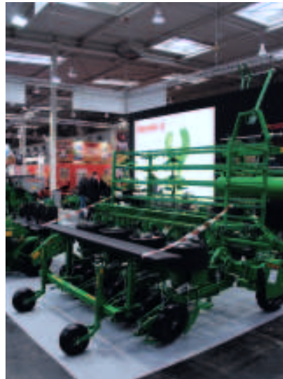
Mit diesen Pflanzmaschinen, auch Revolvermaschinen genannt, von Checchi & Magli (l.) sowie Sfoggia (Mitte) können Pflänzchen aus Trays gepflanzt werden, wobei diese zuvor in den Gestellen platziert werden.
