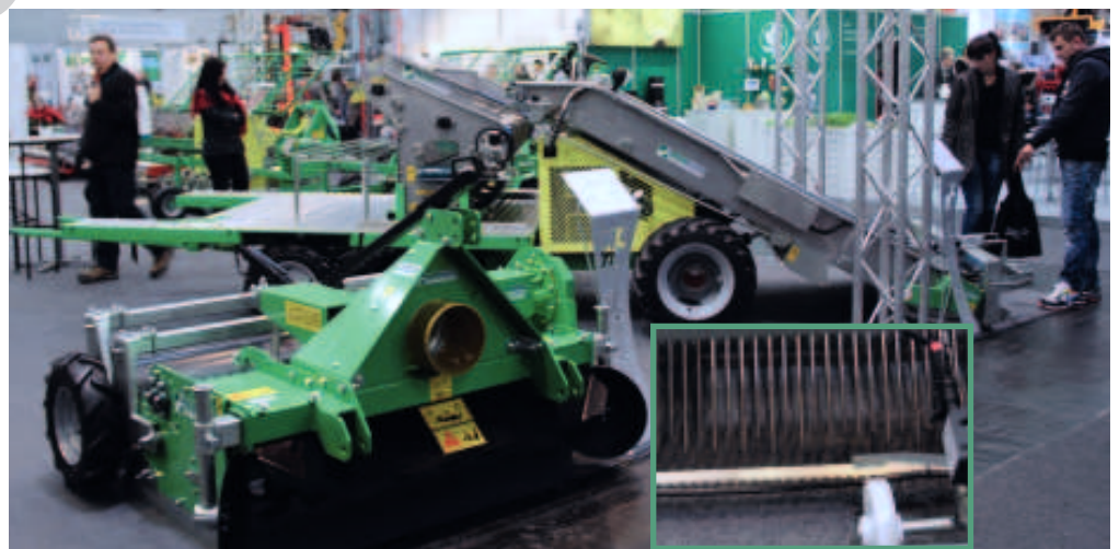
Im Vordergrund die Beetfräse Perfecta 140 von der Firma Trinkel, im Hintergrund die Slide Valeriana, eine Feldsalaterntemaschine, die mit einer Bandsäge den Feldsalat schneidet und dem Shaker 150 die Röschen aufnimmt (kleines Detailbild). Fotos: Setzepfand
